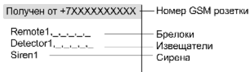
Рис.11 Вид SMS с прописанными устройствами
